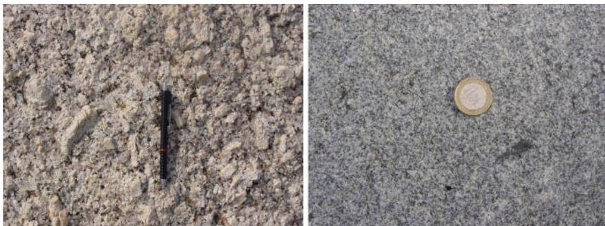
**Figura 7.** Fácies graníticas do Maciço de Nisa: Granito de Nisa, porfiróide (à esquerda); Granito da Alpalhão, de grão fino (à direita).
